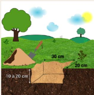
**Creuser un trou** de 30cm par 20cm et de 10 à 20cm de profondeur et aplanir au mieux la surface du fond du trou (*pour que le cadre puisse être posé bien à plat*).
